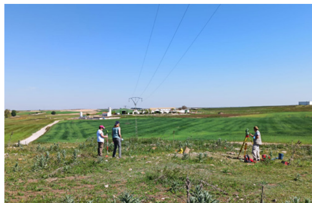
Figura 3.19. Toma de coordenadas con estación total (mayo 2021).
