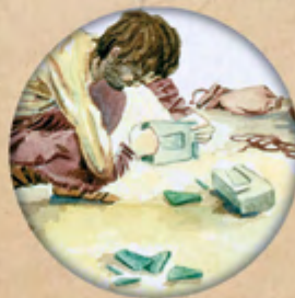
Fase 5. Extracció. Una vegada refredat, traure l'objecte del motle i polir la peça.
