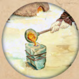
Fase 4. Fabricació d'objectes. Abocar el metall fos dins d'un motle de pedra o argila cuita.
