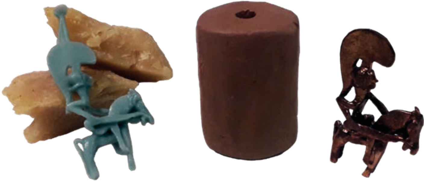
Objectes i materials que reproduïen el procés de fosa de la figura amb la tècnica de la cera perduda: cera, figura modelada en cera, recobriment d'argila i peça acabada.
