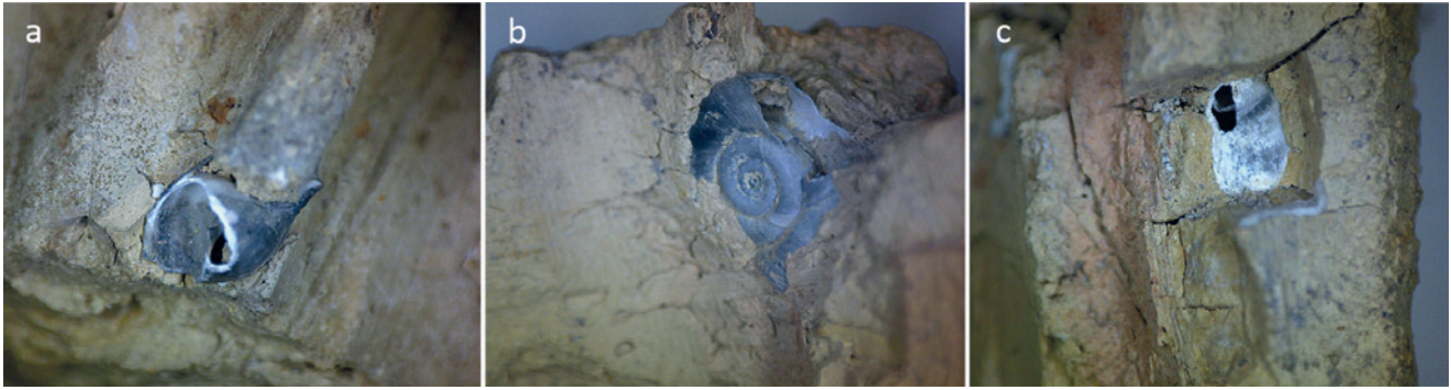
Figura 7.56. Ejemplares de malacofauna en el mortero de barro de los restos constructivos de Cabezo Pardo, vistos con una lupa binocular. a. CP 1000/55-1. b. CP 1063/28-5. c. CP 1063/28-6.
